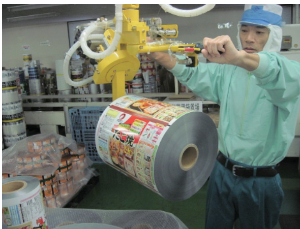
▲重量物移動補助器具などを用いて作業を行う様子
